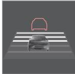
앞차와의 시간 간격을 선택할 수 있습니다. 선택한 시간 간격은 계기판에 1~5개의 수평 라인으로 표시됩니다. 수평 라인이 많을수록 시간 간격이 길고, 수평 라인이 1개만 표시되면 시간 간격이 1초인 것이고 5개가 모두 표시되면 시간 간격이 3초인 것입니다.
