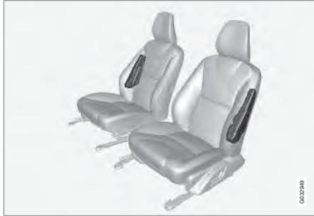
측면 충돌이 있을 때는 SIPS(측면보호 시스템)가 측면 충격의 대부분을 빔, 필라, 바닥, 루프 등의 차체 구조물로 분산시킵니다. 운전석과 앞승객석의 사이드 에어백은 운전자와 앞승객의 가슴과 허프를 보호하는 SIPS의 중요한 구성품입니다.
