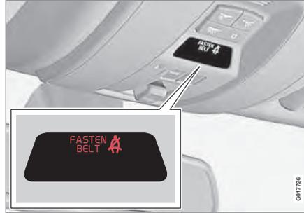
안전벨트를 착용하지 않은 탑승자가 있으면 시청각 경고 시스템이 안전벨트를 착용할 것을 촉구합니다. 청각적 경고 시스템은 차량 속도와 경과 시간에 따라 작동하기도 하고 작동하지 않기도 합니다. 시각적 경고 시스템은 루프 콘솔과 계기판에 위치합니다. 어린이 시트에는 안전벨트 경고 시스템이 적용되지 않습니다.
