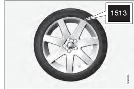
타이어는 시간의 지남에 따라 퇴화됩니다. 생산된 후 몇 년이 지나면 경화되기 시작하면서 마찰 능력/특성이 점차적으로 악화됩니다. 이런 이유로 타이어를 교체할 때는 중고 타이어보다 새 타이어로 교체하는 것이 바람직합니다. 윈터 타이어는 새 타이어를 사용하는 것이 특히 중요합니다. 타이어 번호의 마지막 네 자리 수는 타이어의 DOT(교통부) 마크로서 타이어가 제작된 연도와 주를 가리킵니다. 그림의 1510이라는 숫자는 타이어가 2010년의 15번째 주에 제작되었음을 가리킵니다.
