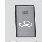
실내공기 순환 기능이 작동하면 버튼의 오렌지색 표시등에 불이 들어옵니다. 실내공기 순환 기능은 나쁜 공기나 배기 가스가 실내로 들어오는 것을 막을 때 사용됩니다. 실내공기 순환 기능이 작동하면 외부 공기가 실내로 들어오지 못합니다.
