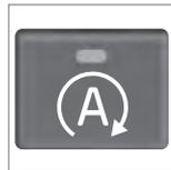
엔진이 자동으로 꺼질 때는 일부 시스템의 기능만 약화될 뿐(온도조절 시스템의 팬속도, 오디오 시스템의 볼륨 등) 대다수 시스템(라이트, 라디오 등)이 정상적으로 작동합니다.
