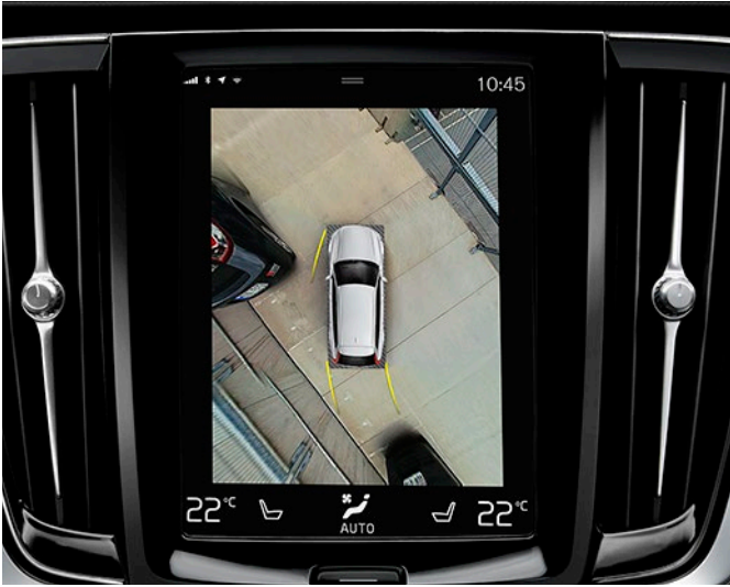
360° 카메라 눈에 잘 띄지 않는 위치에 장착된 360도 카메라는 자동차와 주변 환경에 대한 조감도를 보여줍니다. 귀하 주변의 모든 장애물을 센터 디스플레이에서 확인할 수 있으며, 좁은 공간에서의 주차와 이동을 더욱 쉽게 도와줍니다.
