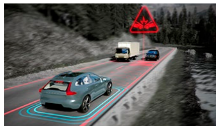
접근 차량 충돌 회피 기능 반대편 차선에서 이동하는 차의 방향을 모니터링하여 충돌을 피할 수 없는 상황이 발생할 경우 차에 제동을 걸어 피해를 줄이거나 예방하도록 도와줍니다.
