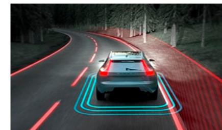
도로 이탈 완화 기능 주행 방향과 다르게 의도하지 않은 도로 이탈이 감지될 경우 스티어링 휠을 조정하고 필요에 따라 브레이크를 사용하여 원래의 도로로 돌아올 수 있도록 도와줍니다.
