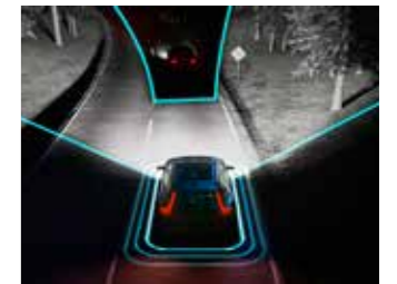
풀 LED 액티브 하이빔 풀 LED 헤드라이트는 다른 운전자들을 눈부시게 하지 않으면서도 항상 최상의 시야를 확보할 수 있는 하이빔을 사용할 수 있도록 합니다. 이 기능은 전방의 도로 사용자들을 감지해 그들의 눈이 부시지 않도록 자동으로 하이빔의 조도를 낮추어 줍니다.
