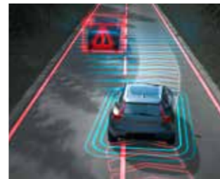
반대 차선 접근 차량 충돌 경감 기능 마주 오는 차량과의 충돌을 피하도록 자동 조향 보조기능을 사용합니다. 차량이 차선을 벗어나 마주 오는 다른 차량의 진로를 침범한 경우 차량이 스스로 제 차선으로 돌아올 수 있도록 합니다.
