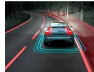
도로 이탈 완화 기능 주행 방향과 다르게 의도하지 않은 도로 이탈이 감지될 경우 스티어링 휠을 조정하고 필요에 따라 브레이크를 사용하여 원래의 도로로 돌아올 수 있도록 도와줍니다.
