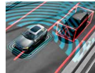
조향 지원 적응 사각지대 정보 시스템 후방의 다른 차량이 시각 지대에 있거나, 동시에 옆 차선에서 빠르게 접근하고 있을 때 운전자의 차량이 차선을 이탈하려고 움직임이 감지되는 경우, 조향 지원 기능이 작동하여 운전자가 차를 원래 차선으로 위치할 수 있도록 도와줍니다.
