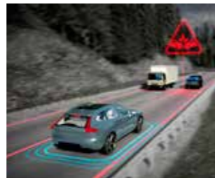
접근 차량 충돌 회피 기능 반대편 차선에서 이동하는 차의 방향을 모니터링하여 충돌을 피할 수 없는 상황이 발생할 경우 차에 제동을 걸어 피해를 줄이거나 예방하도록 도와줍니다.
