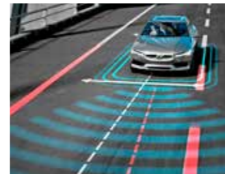
차선 유지 보조 장치 의도하지 않게 차선을 침범할 경우 부드럽게 스티어링을 제어하여 원래의 차선으로 돌아오도록 합니다. 이것이 충분하지 않거나 운전자가 계속해서 차선을 침범할 경우, 스티어링 휠에 진동으로 경고를 보냅니다.
