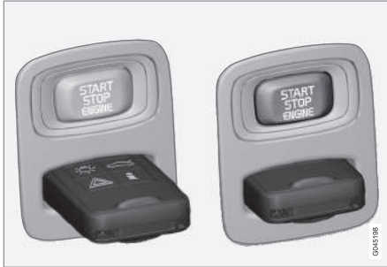
리모컨 포트에 배출/삽입된 리모컨과 START/STOP ENGINE 버튼
